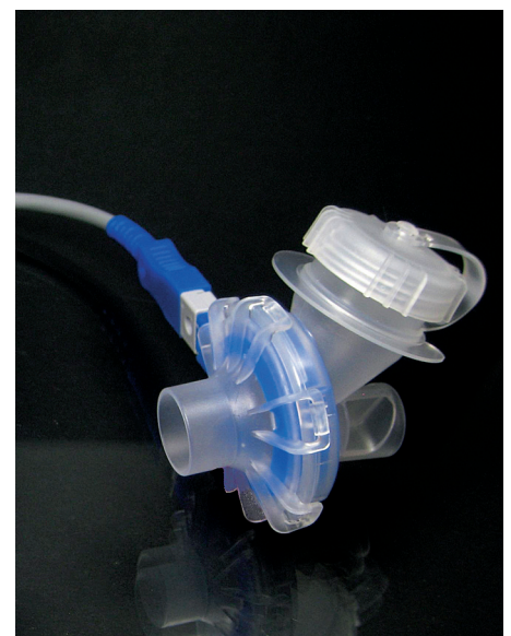
Kleines Gerät mit grosser Wirkung – eFlow Vernebler für eine neue sanfte Therapie für Frühgeborene: Das Medikament wird über in den Trichter oben rechts zur Membran im Innern (blauer Ring) geführt, wo es vernebelt wird. Über die Öffnung links verlässt das vernebelte Medikament das Gerät und gelangt via Nasenschläuche in die Lunge der kleinen Patienten (s. Bild rechts).
